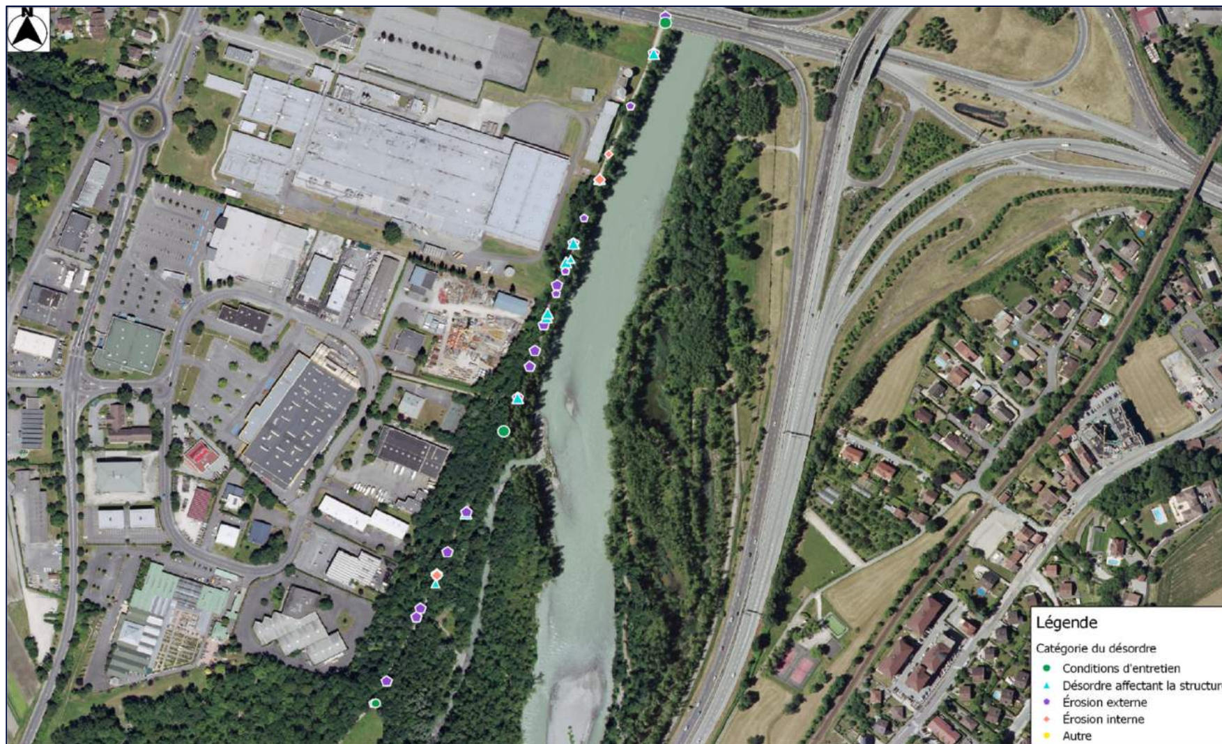
Figure 7 : Cartographie des désordres en aval du pont A411 (digue de la Châtelaine)
