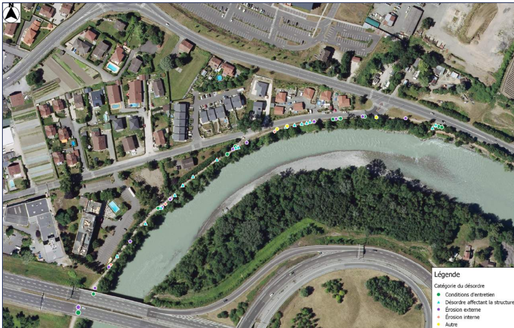
Figure 6 : Cartographie des désordres en amont du pont A411 (digue des Escours)
